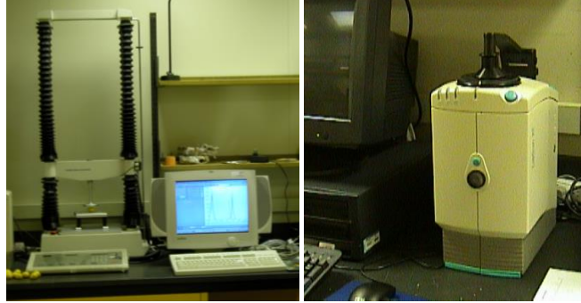
شكل (٥). جهاز لقياس اللون (يمين) وجهاز قياس الخواص الميكانيكية (القوام) لاختبارات الكبس والاحتراق والقص للتمور (يسار) والتحكم بهما بالحاسب الآلي. (المصدر: الحمدان وحسن، ٢٠٠٣).
